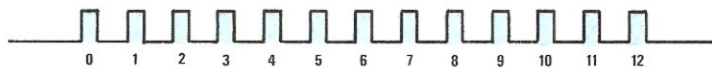
Fig. 2 Gli impulsi forniti in uscita dall'integrato MM.53200, come è possibile vedere sullo schermo di un oscilloscopio, sono 13, tutti identici tra di loro e della durata di 11,52 millisecondi, segue ad essi una pausa di identico tempo e dopo questa altri 13 impulsi. La durata degli impulsi e delle pause viene determinata dal valore del condensatore e della resistenza applicati sul piedino 13.
