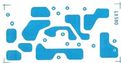
Fig. 2 Disegno a grandezza naturale del circuito stampato LX.590 visto dal lato sul quale verranno collocati i componenti.
