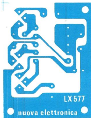
Fig. 2 Disegno a grandezza naturale del circuito stampato.
